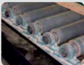
Přehřáté ložisko dopravníku
